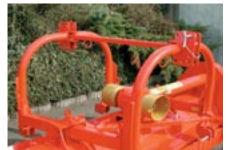
Die mechanische Parallelogramm-Seitenverstellung (auf Wunsch hydraulisch) sowie der serienmäßige Zapfwellendurchtrieb.
